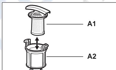
1. Поверните фильтр (A) против часовой стрелки и извлеките его.
